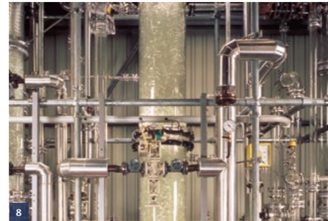
8 化学器械 几何结构精准的杜安®玻璃管应用于大型设备 9 观察窗 杜安®玻璃管代表持久稳定的清晰度 10 臭氧发生器 杜安®玻璃管作为绝缘体
