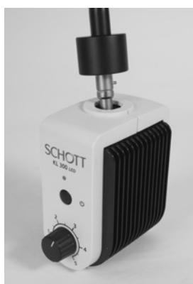
Inserte la clavija hueca del adaptador incluido en la toma de conexión de la fuente de luz prevista para ello. Asegúrese de que su fuente de luz fría KL 300 LED solo funcione en el rango de tensión especificado y con el adaptador incluido.
