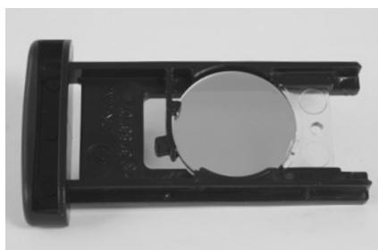
Biegen Sie zur Entnahme den Haltebügel leicht nach links und entnehmen Sie den Filter.
