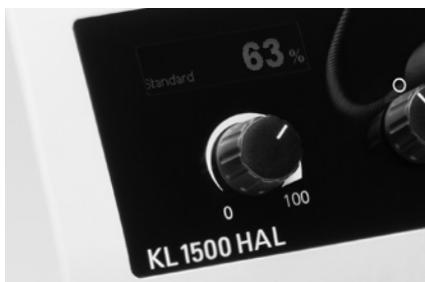
Je nach Lichtstärke werden im Display drei unterschiedliche Werte angezeigt, die eine Indikation für die Lebensdauer der Lampe geben:
