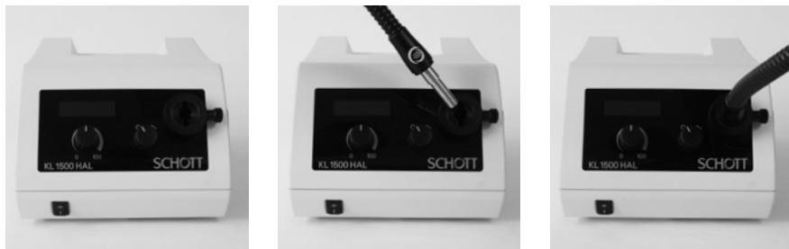
Il supporto della guida luminosa è dotato di un sistema di sensori (spegnimento automatico) che permette il funzionamento della lampada solo se una guida luminosa raccomandata si trova nell'apertura prevista per essa. Questo previene l'abbagliamento quando si opera senza guida di luce, ad esempio quando si cambia accidentalmente la guida di luce senza spegnere la sorgente luminosa all'interruttore principale.
