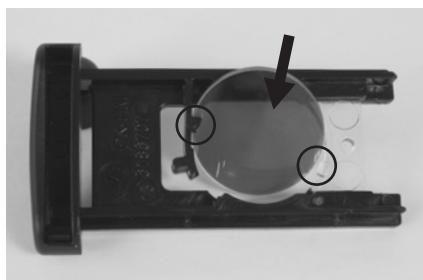
3. Cliquer fermement le filtre d'insertion en exerçant une légère pression en haut à droite. Le filtre est maintenant bien à plat dans le support.
