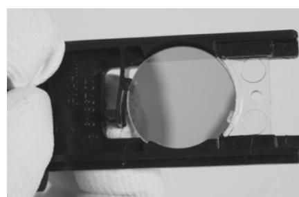
Möchten Sie die Lichtquelle kurzzeitig ohne Filter betreiben, so ziehen Sie den Schieber nur bis zum ersten Rastpunkt heraus. Der Filter befindet sich in dieser Position noch in der Lichtquelle, jedoch nicht mehr im Strahlengang.
