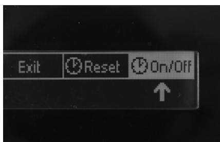
Seleccione el submenú “On/Off” para visualizar el tiempo total de funcionamiento. Gire el regulador de intensidad de la luz para seleccionar “On” y confirme pulsando brevemente (aparece una marca en el campo del menú). Seleccione “Menü” y luego “Exit”. La lámpara se enciende de nuevo.
