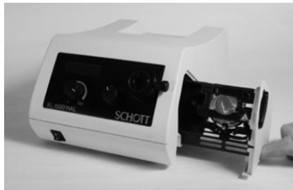
Öffnen Sie das Lampenfach durch Herunterdrücken an der vorgesehenen Vertiefung und gleichzeitiges Ziehen bis zum Anschlag.
