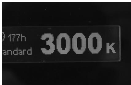
Per fare questo, premere il controllo dell'intensità della luce per più di cinque secondi per entrare nel controllo del menu. Non appena la fonte di luce è nel controllo del menu, la lampada si spegne.
