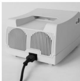
Durch Betätigung des Hauptschalters können Sie die KL 1500 HAL ein- und ausschalten. Ist das Gerät eingeschaltet, leuchtet die Anzeige im LCD Display. Um die Stromversorgung zu trennen, ziehen Sie den Netzstecker! Die KL 1500 HAL ist zur Schonung der Halogenlampe mit einem Softanlauf ausgerüstet, der einen zu hohen Einschaltstrom reduziert.
