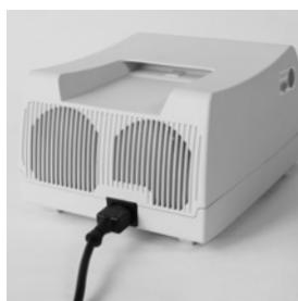
Pulsando el interruptor principal, puede encender y apagar la KL 1500 HAL. Al encender el aparato, la pantalla LCD se ilumina. Para desconectar el suministro eléctrico, extraiga la clavija del enchufe. Para proteger la lámpara halógena, la KL 1500 HAL está equipada con un arranque suave que reduce la corriente de entrada excesiva.
