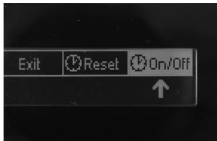
Selezionare il sottomenu «On/Off» per visualizzare il tempo totale di funzionamento. Ruotare il controllo dell'intensità della luce per selezionare «On» e confermare premendo brevemente (un segno di spunta appare nel campo del menu). Selezionare «Menü» e poi «Exit». La lampada si accende di nuovo.
