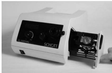
Aprire il vano della lampada premendo sull'apposito incavo e tirandolo contemporaneamente fino all'arresto.
