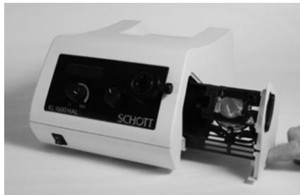
Ouvrez le compartiment de la lampe en appuyant sur le renflement prévu à cet effet et en tirant en même temps jusqu'à la butée.
