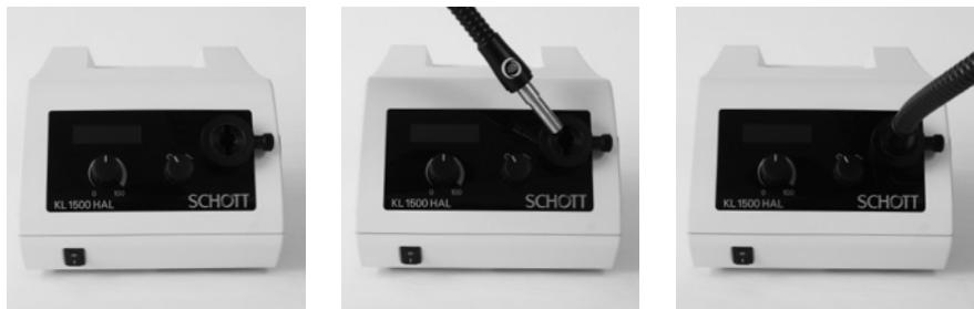
Die Lichtleiteraufnahme ist mit einer Sensorik (Abschaltautomatik) versehen, die einen Betrieb der Lampe nur gestattet, wenn sich ein empfohlener Lichtleiter in der dafür vorgesehenen Öffnung befindet. Eine Blendung beim Betrieb ohne Lichtleiter, z. B. beim versehentlichen Wechseln des Lichtleiters ohne die Lichtquelle am Hauptschalter auszuschalten, wird dadurch vermieden.
