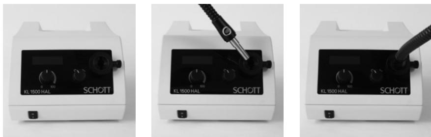
Le logement de la fibre optique est équipé d'un système de détection (extinction automatique) qui ne permet d'utiliser la lampe que si un guide de lumière recommandé se trouve dans l'ouverture prévue à cet effet. Cela permet d'éviter tout éblouissement en cas de fonctionnement sans guide de lumière, par exemple en cas de changement accidentel du guide de lumière sans éteindre la source lumineuse à l'aide de l'interrupteur principal.
