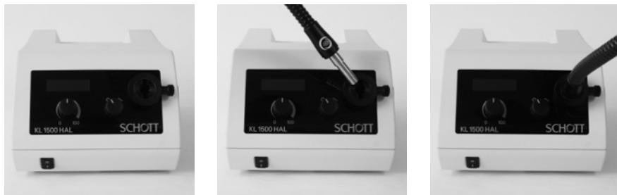
El soporte de la guía de luz está equipado con un sistema de sensores (desconexión automática) que sólo permite el funcionamiento de la lámpara si una guía de luz recomendada se encuentra en la abertura prevista para ello. Esto evita el deslumbramiento durante el funcionamiento sin guía de luz, por ejemplo, cuando se cambia accidentalmente la guía de luz sin apagar la fuente de luz en el interruptor principal.
