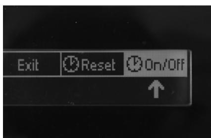
Sélectionnez le sous-menu « On/Off » pour afficher la durée totale d'utilisation. En tournant le régulateur d'intensité lumineuse, sélectionnez « On » et confirmez en appuyant brièvement (Un crochet apparaît dans la zone de menu). Sélectionnez « Menu », puis « Exit ». La lampe s'allume à nouveau.
